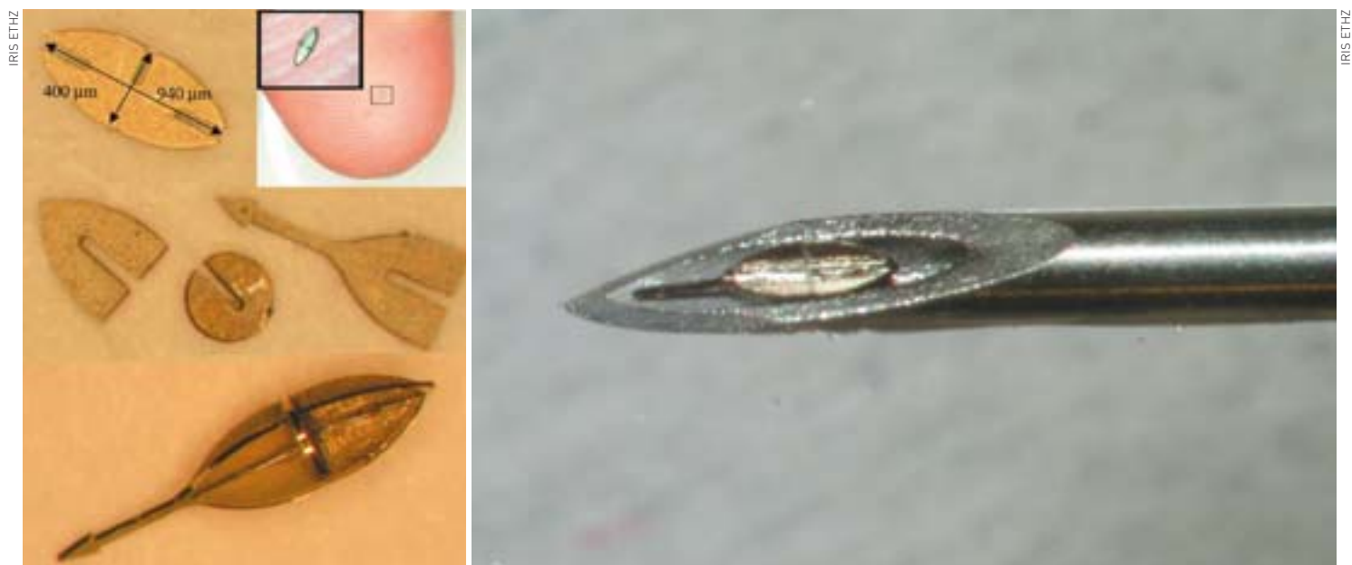
(l.) Am Institut für Robotik und Intelligente Systeme IRIS der ETH Zürich entstehen drahtlose, magnetisch gesteuerte Mikroroboter, die heikle Mikrooperationen durchführen oder Medikamente an schwer erreichbare Ziele, wie ins Gehirn oder Auge transportieren könnten. Im Bild: Mikroroboter auf der Spitze einer Injektionsspritze für den Einsatz im Auge. (r.) Ein autonomer IRIS-Mikroroboter (oben rechts auf Fingerkuppe), der ohne physische Verbindung zur Aussenwelt agieren kann, und (umstehend) in seine Einzelteile zerlegt.
